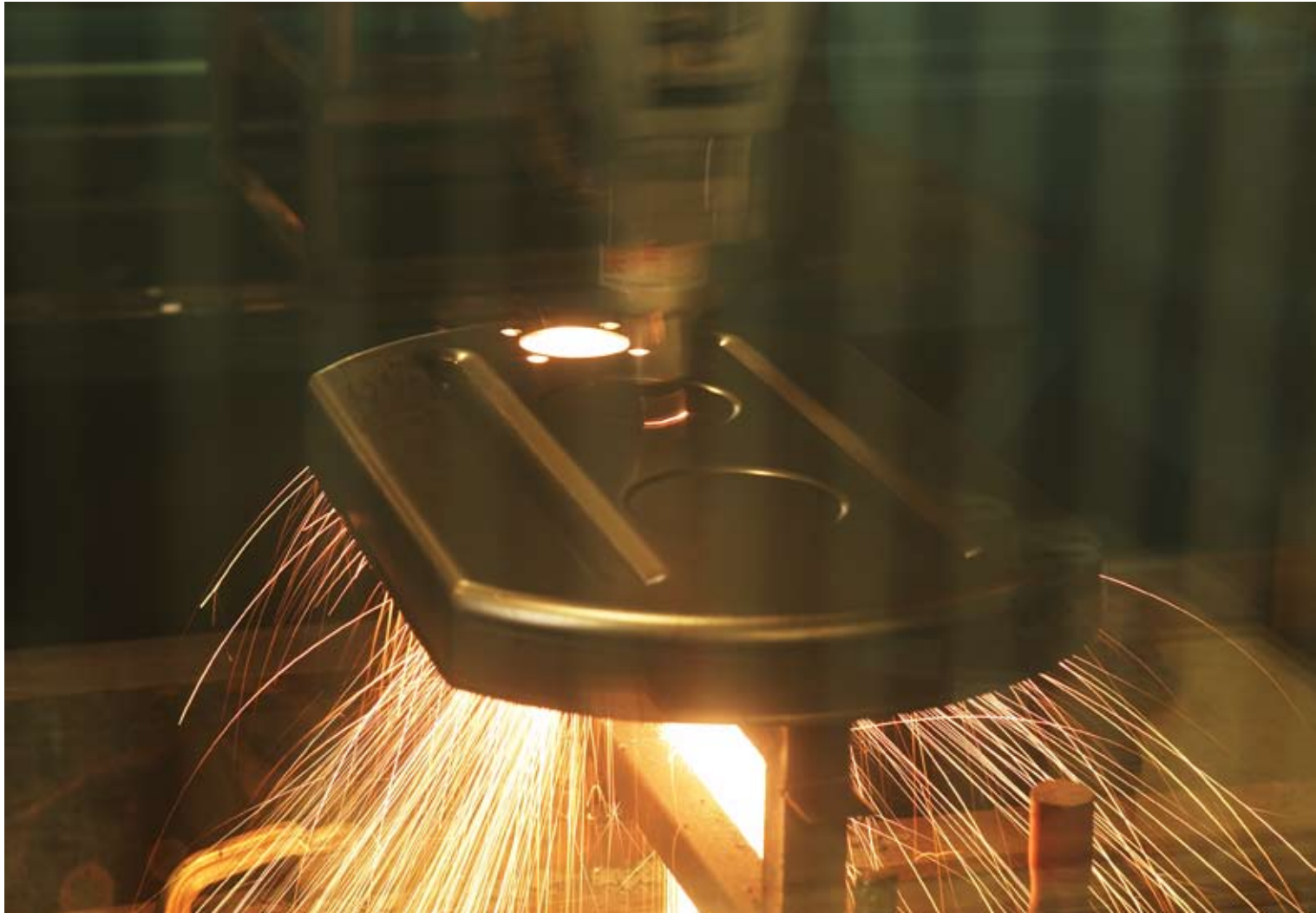
3D-rajausta Suoja-Expertin komponenttiin.
